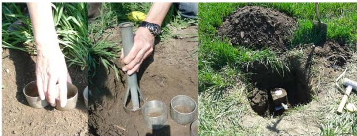
Abb.2: Probenahme 2013 (Stechzylinder 5cm in 10-15cm und 25-30cm Tiefe)
